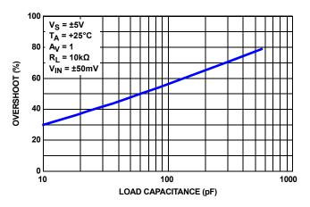
FIGURE 23. SMALL SIGNAL OVERSHOOT vs LOAD CAPACITANCE
