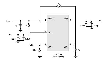
FIGURE 27. BASIC TEST CIRCUIT
