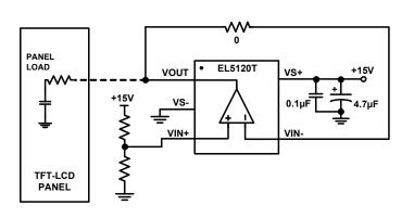
FIGURE 1. TYPICAL TFT-LCD V<sub>COM</sub> APPLICATION
