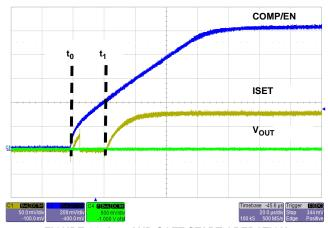
FIGURE 14. I<sub>SET</sub> AND SOFT-START OPERATION
