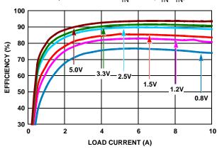
FIGURE 3. EFFICIENCY vs LOAD CURRENT (12VIN)
