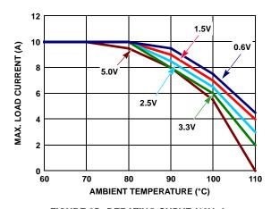
FIGURE 25. DERATING CURVE (12VIN)
