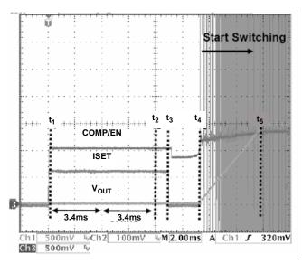
FIGURE 15. I<sub>SET</sub> AND SOFT-START OPERATION
