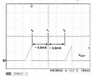
FIGURE 19. OVERCURRENT RETRY OPERATION
