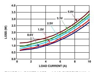
FIGURE 24. POWER LOSS vs LOAD CURRENT (12VIN)
