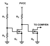
FIGURE 20. SEQUENCE CIRCUIT
