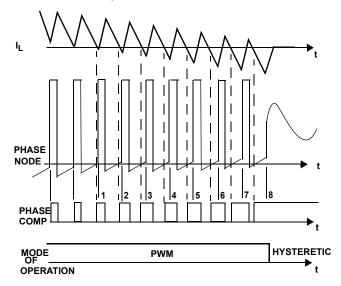
FIGURE 6. MODE CONTROL WAVEFORMS
