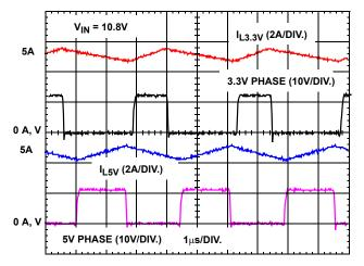
FIGURE 4. OUT OF PHASE OPERATION
