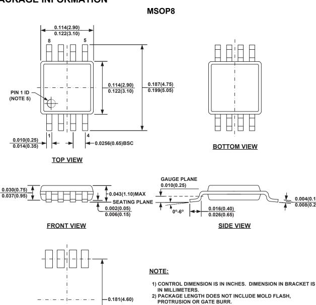
3) PACKAGE WIDTH DOES NOT INCLUDE INTERLEAD FLASH OR PROTRUSION.
