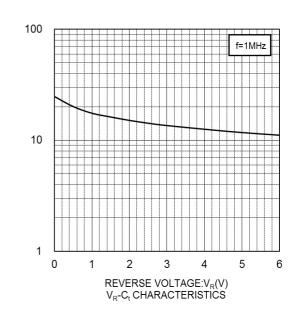
CAPACITANCE BETWEEN TERMINALS:C<sub>t</sub>(pF)
